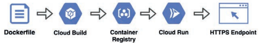
Afbeelding 1: Stappenplan van Cloud Run deployment.
