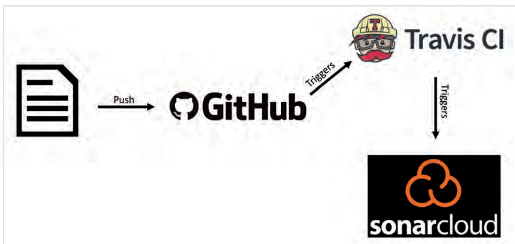
Figuur 1: Overzicht van de werking van de automatische bouwstraat
